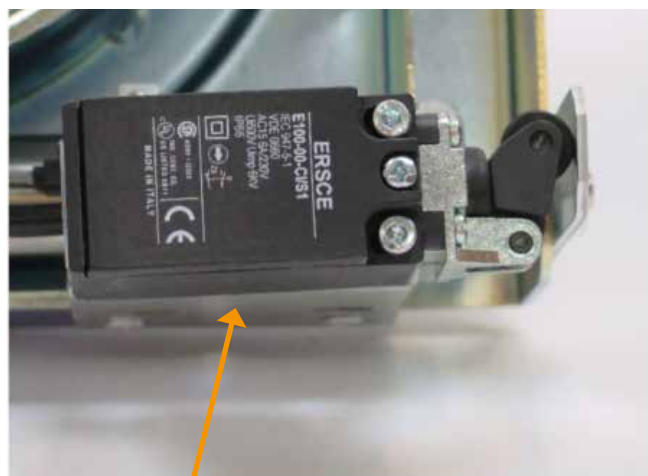
Microrupteur fixé sur l'amortisseur.
