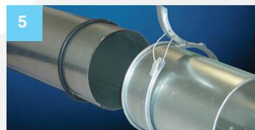
Coloque la junta tórica en la pieza cortada de la tubería y deslice un manguito Quick-Fit sobre la tubería.
